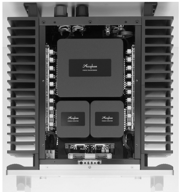
[写真14] A-100の内部。約1kVAの大型トイダル電源トランスと68000 \mu Fの大型電源コンデンサーが内部の大半を占有。左右に配置された大型放熱器には、ハイブリッドIC化した電圧増幅回路と、10パラ接続のパワーMOS-FET群を搭載したパワーアンプ基板(タイトル写真参照)が取り付けられている。フロントパネル裏側の基板に搭載されているのは、メーター駆動回路/保護回路/安定化電源回路だ
