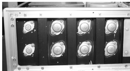
【写真5】 P-300の放熱器まわり。左端2個のTO-66パッケージトランジスターはドライバー一段の東芝2SC783と2SA483、残り6個のTO-3パッケージは3バラ出力段の東芝2SC1079と2SA679
