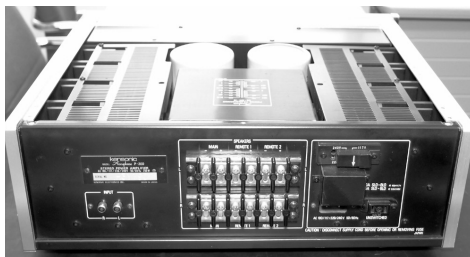
[写真2] 天板を外したP-300の後ろ姿。各ブロックはシールドケースで覆われている。リアパネルのスピーカー端子はプラスネジ型で、MAIN/REMOTE1/REMOTE2の3系統を装備
