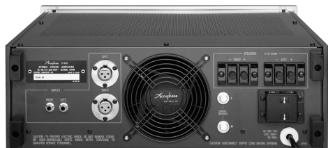
【写真7】 1979年6月に発売されたP-400（物品税込41万円）の外観。第2世代のパワーアンプで、右端のプッシュスイッチがA級/AB級の動作モードセレクター。8Ω出力はA級モードが50W/ch、AB級は200W/ch。リアパネルには、放熱器温度に応じて回転速度が連続的に変わる空冷ファンを装備
