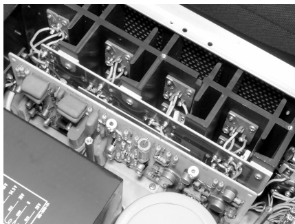
【写真6】 出力段まわりの配線。トランジスターソケットとつながっている奥の基板がドライバー以降の電流増幅回路で、手前の基板が電圧増幅回路。基板間の中央部には、出力段から初段への飛び付きを防ぐシールド板が設けてある
