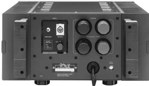
[写真13] 1991年12月に発売された純A級100WモノラルアンプA-100(税別95万円)の外観。両サイドに大型放熱器を配置して自然空冷で純A級100Wを実現。大型スピーカー端子を2系統装備してバイワイヤリングに対応。57kgと重いので、運搬用にフロントには頑丈なハンドル、リアには縦置き時にスピーカー端子を保護するスタンドが付いている
