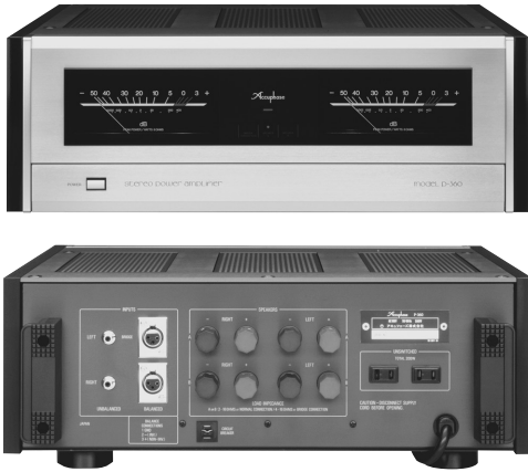
[写真11] 1991年3月に発売されたP-360(税別37万円)の外観。P-300シリーズの後継機で機能等の基本は300シリーズを踏襲。フロントパネルは左右対称配置に変更され、スピーカー端子を2系統装備。保証出力は8Ω200W/ch, 2Ω400W/chで、ブリッジ接続で600W/8Ωモノラルアンプになる
