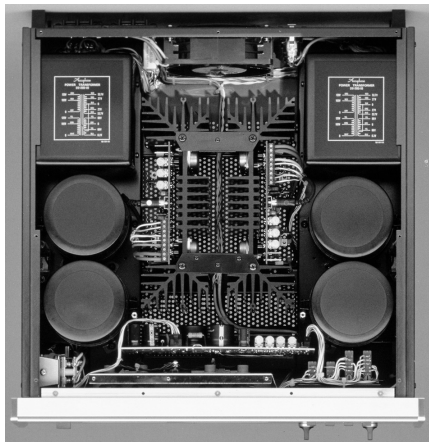
【写真8】 P-400の内部。電源トランスからLRを分けたデュアルモノラル構成で、中央部にTO-3パッケージMOS-FET群とパワーアンプ基板を取り付けた放熱器、左右にLR独立の電源を配置。フロントパネル裏の基板には、安定化電源回路/保護回路/メーター駆動回路が搭載されている
