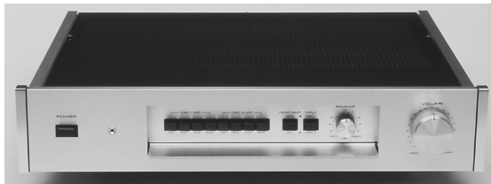
[写真1] ディスク専用プリアンプC-220の外観(1977年6月発売、物品税込22万円)。フロントは左から順に、出力セレクターを兼ねた電源スイッチ、DISC1とDISC2のインピーダンス切り換え(各4)、ヘッドアンプのON/OFF、入力セレクター、バランス、ボリュームを配置。リアパネルは左端がGND端子で、次がDISC1、DISC2、EXT PREAMPの入力。出力はFIXED OUTPUTとMAIN OUTPUT(RCAとXLR)を装備
