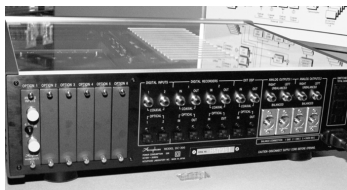
[写真10] DC-300のリアパネル。オプションボード増設スロットが6つ装備され、A/Dコンバーターを搭載したライン入力ボード1個を標準装備。本体には同軸とトスリンクのデジタル入出力端子と、RCAとXLRの2系統アナログ出力を装備
