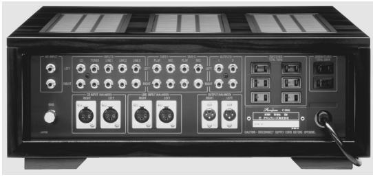
[写真6] 内部信号処理をフルバランス化したC-280L(1987年2月発売、物品税込64万円)のリアパネル。アンバランス入力に加えて、CDとLINEのバランス入力が装備された。プリアウトは2系統のRCAと1系統のXLRを装備
