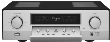
[写真13] 第6世代機C-3800(2010年7月発売、税別170万円)の外観。40周年記念モデルなので、コストの制約なしにアンプの理想を徹底追求。AAVA回路を片チャンネルに2個使うバランス型AAVAの導入でスペースがなくなり、フォノイコライザーズロットは省かれた
