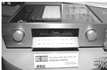
[写真8] 1996年全日本オーディオフェアに出品されて話題を呼んだデジタルプリアンプDC-300(1996年11月発売、税別98万円)。アナログ感覚のボリュームには、音量を絞っても音質劣化が極小のHANS方式デジタルボリュームを採用
