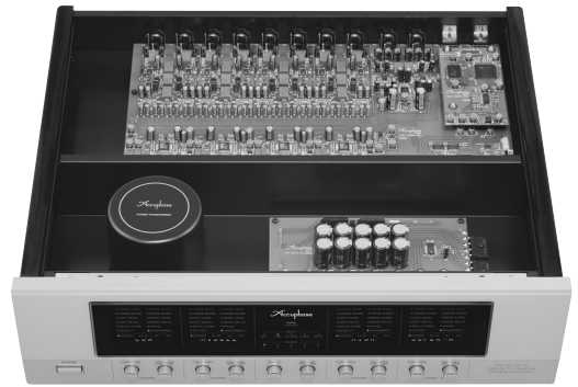
[写真18] 2011年1月に発売された第3世代機DF-55の内部 (税別75万円)。DF-45と同様に複数台使用して5ウエイ以上にも対応でき、演算精度の向上で5mm単位の信号遅延が可能だ。モノラルモードが加わってLR独立使用も可能になった
