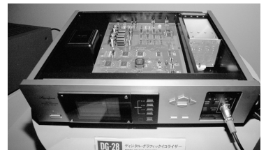
[写真19] 1996年10月の全日本オーディオフェアで注目された、自動音場補正機能付きデジタルグラフィックイコライザーDG-28の内部。(1997年5月発売、税別53万円)。ディスプレイはモノクロ液晶でリアに4つの拡張スロットを装備
