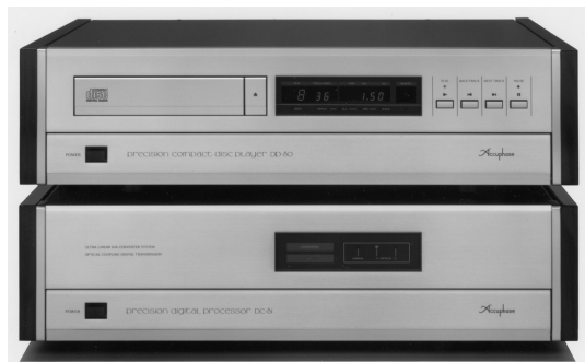
[写真1] 1986年7月に発売され、トスリンク光伝送方式の採用と抜さん出た音質で話題を呼んだ、セパレート型CDプレーヤーのデビュー作。上がCDトランスポートDP-80(税別24万円)で、下がデジタルプロセッサー DC-81(税別40万円)
