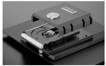
[写真11] DP-800に搭載された、物量をふんだんに投入した自社開発の SACD/CDメカ。1レンズツインレーザーの SACD/CD兼用ピックアップを搭載し、アルミ合金ブロックから削り出した精密加工の高剛性部材を用いたメカで総重量は8.2kg
