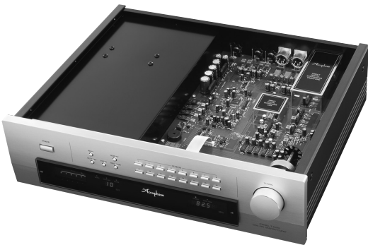
[写真22] 局部発振回路とステレオ復調回路にデジタル信号処理方式を導入し、アナログ出力以外にデジタル出力も装備したFMチューナー T-1000の内部 (2005年7月発売、税別28万円)。IF回路がアナログ信号処理なので部品点数が多い
