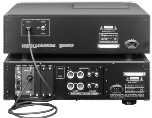
[写真9] CDのPCM信号だけでなくSACDのDSD信号もデジタル伝送可能なプライベートリンク「HSリンク」で接続されたDP-100とDC-101のリアパネル。LAN用のRJ45端子を採用しているので、市販のLANケーブルも使用可能
