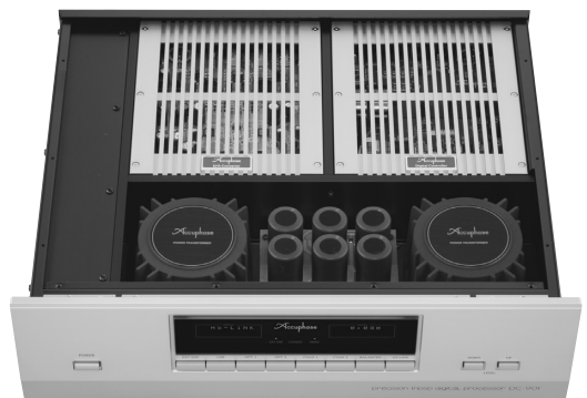
[写真13] DP-900とペアになるデジタルプロセッサー DC-901の内部 (税別110万円)。USB オーディオクラス2.0に対応したUSB入力を装備してPCオーディオにも対応。DACにはESSの32ビット入力超高性能8チャンネルDACをLRに2個ずつ投入
