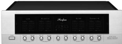
[写真17] 2005年8月に発売された第2世代機DF-45 (税別70万円)。カットオフ周波数を59ポイント内蔵し、4ウエイのDividerユニットを標準装備して増設スロットを廃止。最大96dB/octの減衰特性で、1cm単位の信号遅延機能を装備
