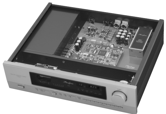
[写真23] 局部発振回路とIF回路以降の信号系をすべてデジタル化し、ソフトウェア処理で受信性能と音質を飛躍的に改善したFMチューナー T-1100の内部 (2010年9月発売、税別33万円)。IF回路のデジタル化により部品点数が激減した
