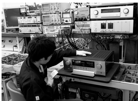
【写真10】 動作状態での振動試験。信号を入れてセットを加振し、ハンダ付け不良/接触不良/異物混入がないかをチェック
