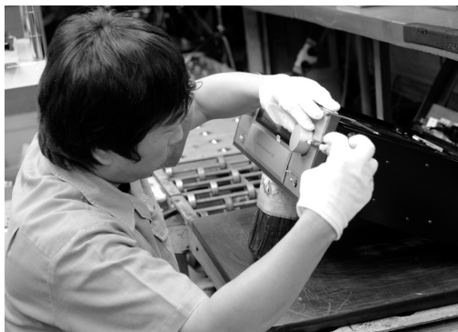
【写真9】 パネル/ツマミ/ケースなどの外装部品取り付け作業。パネルやツマミの位置を微調整して、取り付け誤差が目視で判別できないレベルまで徹底して追い込む
