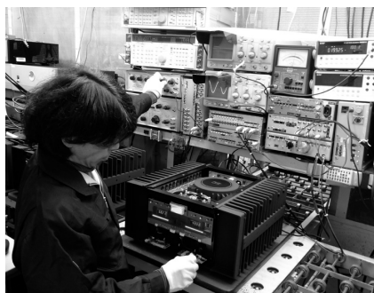
【写真8】 連続運転によるエージングが済んだら、その製品が達成できる最良ポイントに追い込む入念な調整を行い、全項目の性能測定を行う
