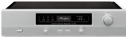
[写真16] 第3世代フォノイコライザーアンプC-47のフロント外観。スイッチは左から順に、電源/MC・MM切り換え/ゲイン/フィルター/負荷インピーダンス/入力セレクター
