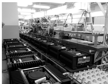
【写真7】 動作チェックに合格した製品は、初期不良の摘出と音質を安定させるなどの目的で24時間以上の連続運転試験を行う
