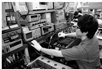
【写真6】 本体に外装を除く部品を取り付けて動作可能な状態になったら、セットに通電して動作チェックを行う
