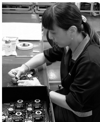
【写真5】 CDドライブメカの組み立て作業。プリント基板の組み立てなどは外注だが、入念な配慮と高い精度が要求される部品の組み立ては社内で行っている
