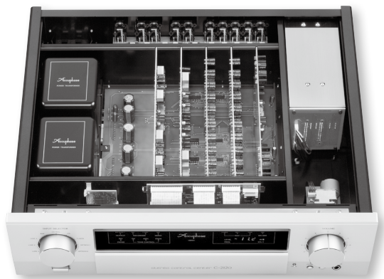
[写真3] C-2120の内部。デュアルモノラル構成で、右後方にオプションスロットケースがある
