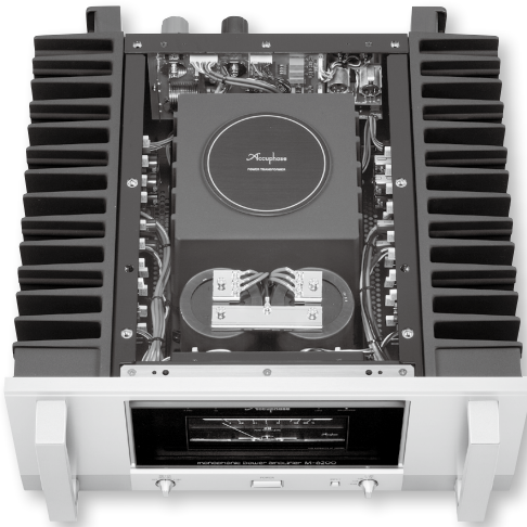
[写真13] M-6200の内部。バランスドリフトセンシング経路を短縮するため出力保護回路と入力アンプを同一基板に収納。両サイドのパワーアンプユニットはアンプの入出力と電圧増幅部の出力HとLどうしを並列接続
