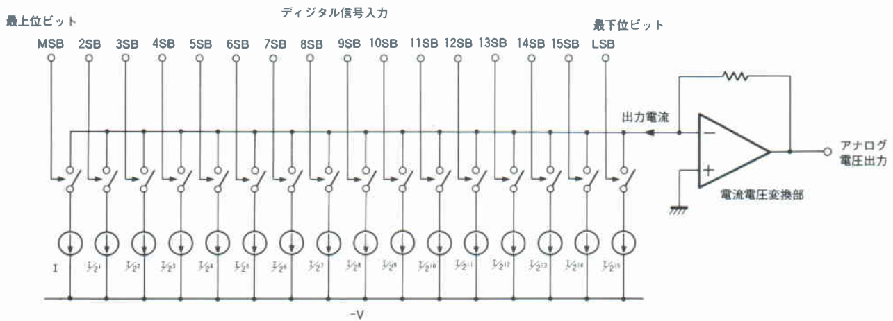
第10図 電流加算型D/Aコンバーターの動作原理
