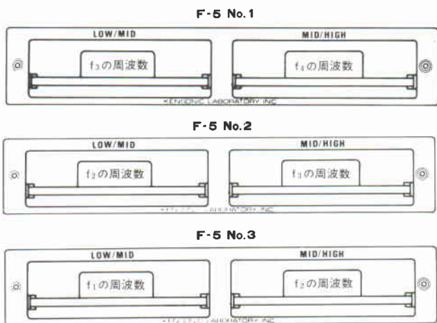
第18図 より完全な並列接続5ウェイ方式のクロスオーバー・ボード
