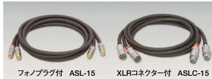
●型式 8芯マルチハイブリッド構造 ●中心導体部 [高純度7N銅線+3種銅線] ●外被絶縁体 PVC ダークブラウン、φ8.7mm ●絶縁体 ポリエチレン ●ループ間総直流抵抗 20mΩ/m ●電極間静電容量 378pF/m ●絶縁抵抗 40MΩ/km
