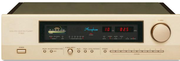
古今の名曲・名演奏や音楽情報など気楽に楽しめるFM放送は、私たちに教養と安らぎを与えてくれる重要なメディアです。T-1100は、「DDSを採用した新開発フロントエンド」を搭載、最新の高周波テクノロジーと先進デジタル技術との融合をさらに推し進めた、最高峰FMステレオ・チューナーです。中間周波数(IF)段以降に高速度・高精度DSPを採用して、「可変IF帯域フィルター回路」「マルチバス・リダクション(MPR)機能」「FMデジタル復調器」「DS-DCステレオ復調器」など主要回路のほとんどを、全く新しい発想によるデジタル信号処理技術によって実現、電波の強弱・混信状況などあらゆる条件に対応して希望の局を受信でき、高品質な音と高調の性能を達成しました。さらに、高品位のデジタル出力端子やバランス・アナログ出力も装備しています。また、操作性に優れたバリス・チューニング方式によるマニュアル選局が可能で、10局のメモリー呼び出しができるステーション・ボタンを装備しています。
