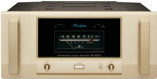
M-6200は、パワーアンプの理想形を追求し、歴代最高の性能と魅力溢れる音を目指した、本格的「モノフォニック・パワーアンプ」です。ディスクリート構成の超低雑音インスツルメンテーション・アンプにより増幅部をフルバランス伝送化、さらに「MCS+回路」とカレント・フィードバック増幅回路を搭載してGAIN MAX時127dB、GAIN -12dB時133dBのSN比を実現、2台のパワーアンプユニットを並列動作させることにより、極めて低い出力インピーダンスのパワーアンプを実現し、超低インピーダンスまで定電圧駆動を可能にしています。強力電源部と「ハイパワー・トランジスター」16パルレル・プッシュプル構成で、1Ωの超低インピーダンス負荷時1,200W（音楽信号）を達成。出力回路を低インピーダンス化し、ダンピング・ファクター1,000を実現しています。モノフォニック・パワーアンプとしての堂々たる風格と量感を備え、音質面では迫力あるダイナミズムと微細な表現能力の再現を徹底的に追求、音楽感動を生々しく伝えてくれます。
