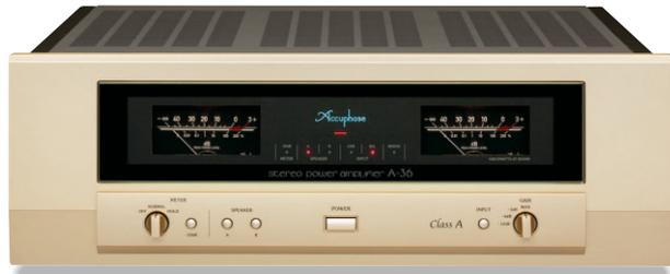
磨き上げた結晶・・・純A級ステレオ・パワーアンプの基本モデル——A-36は、A-200やA-70などの卓越した設計テクノロジーを受け継ぎ、音に対するこだわりと魅力溢れる音質を追求して、純A級ステレオ・パワーアンプとして細部に至るまで念入りに「磨き上げた」充実のベーシック・モデルです。出力素子に「パワー-MOSFET」をチャンネル当たり3/4パルレル・プッシュプル構成、インスツルメンテーション・アンプ方式を採用して信号経路をバランス伝送化、「MCS+」回路、カレント・フィードバック増幅回路を搭載して、より一層性能・音質を向上させました。強力な電源部により、1Ωの低インピーダンス負荷で150W（音楽信号）の余裕ある出力を実現、さらにブリッジ接続にして、より大出力モノフォニック・パワーアンプにアップグレードすることができます。また、出力回路にはリレーの代わりに機械的接点がなく長期信頼性に優れた「MOSFETスイッチ」を使用するなど、最高グレードの素材や回路を巧みに駆使することにより、徹底的に低インピーダンス化し、DF（ダンピングファクター）:400を実現しました。
