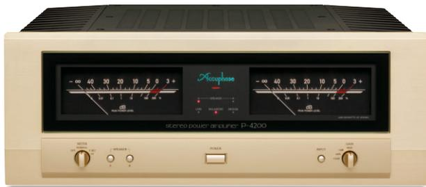
A-200などの卓越した設計テクノロジーを受け継ぎ、最新技術を惜しみなく投入して高いパフォーマンスを実現した本格的な「ステレオ・パワーアンプ」です。入力段にはインスツルメンテーション・アンプを導入して信号経路をフルバランス伝送化、さらに「MCS+」回路とカレント・フィードバック増幅回路を搭載して、音質のさらなる向上を図りました。アンプ全体の低インピーダンス化とエネルギーロスを低減して、「ダンピングファクター:500」を達成。出力レールの代わりに機械的接点がない「半導体(MOSFET)スイッチ」を採用し、理想的なスピーカー駆動を追求しました。高効率大型トイダルトランスと大容量フィルター・コンデンサーによる強力電源部、出力段は広帯域ハイパワートランジスタの3パラレル・プッシュプル構成で、スピーカーを定電圧駆動します。また、P-4200を2台使用したブリッジ接続により、さらに1,000W/2Ωのモノフォニック・アンプにアップグレードすることができます。
