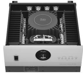
1200VAクリーン電源装置PS-1220の内部。歪み補正アンプは、放熱器と合体した10バラMOS-FET出力段の電流増幅部が左右に配置され、並列接続されている
