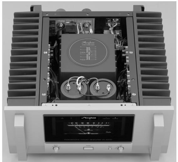
【写真4】 独自の工夫で2つのパワーアンプユニットの並列接続を実現したM-6000の内部。左右の放熱器にMOS-FET 8バラ出力段のパワーアンプユニットを搭載し、入力と中間点と出力を並列接続して16バラ相当のハイパワーアンプを構築
