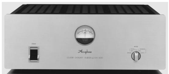
[写真8] 500VAクリーン電源の第1弾PS-500(1996年3月発売、税別30万円)。出力コンセントはリアに2Pが3口、3Pが2口付いている。次世代のPS-500V以降は容量が510VAにアップされた
