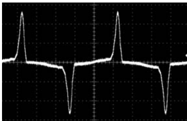
写真② 電源ラインの電圧波形(ひずみ率:約3%)
