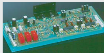
メーター回路/プロテクション回路等を搭載したAssy
