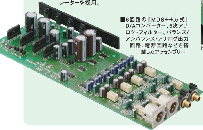
アンバランス/バランス独立構成の「Direct Balanced Filter 回路」搭載
