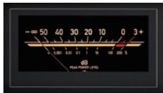
-50dBまで表示可能な 高感度アナログ式 パワー・メーター
