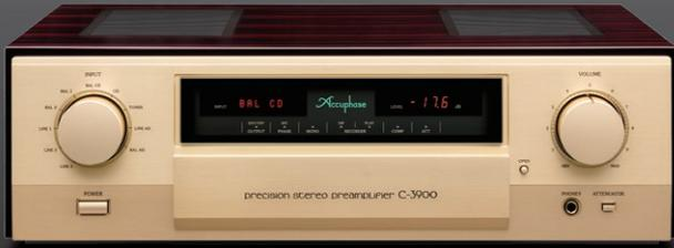
C-3900は創立50周年を記念して開発した最上位のプリアンプです。一般的なプリアンプは、入力信号を抵抗体で減衰させた後にアンプで増幅するためノイズが増加してしまいます。一方アクフェーズの「AAVA」は様々な増幅度のV-I(電圧・電流)変換回路の組み合わせでダイレクトに音量を調整するため、インピーダンスと周波数特性が変わらず音質の変化がありません。また、ボリューム位置によるノイズレベルの変化が極めて少なく、実用的な音量レベルでのSN比も優れています。C-3900では「AAVA」の2回路平衡駆動である「Balanced AAVA」を、さらに2回路並列駆動させた「Dual Balanced AAVA」を搭載することで、ノイズレベルは従来機種に比べ約30%減少しました。「ボリューム・センサー機構」は、滑らかな動作、重厚な操作感、緻密な位置検出を実現しています。C-3900は心が震えるほどの感動を味わえる最高峰のプリアンプです。なおステレオ・フォノ・アンプC-47を接続すれば、アナログ・レコードの演奏も楽しみいただけます。
