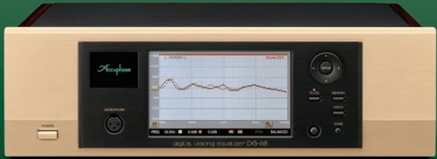
DG-68は最先端デジタル・テクノロジーを駆使した第5世代のデジタル・ヴォイシング・イコライザーです。高精細・高解像度のIPS液晶を採用し、スタイラスペンで希望のカーブを自在に描いての音場補正が可能です。操作性と豊富な表示機能について研究を行い、より簡単にスピーディーな操作を実現しました。リアパネルには標準で豊富な入出力端子(HS-LINK、COAXIAL、OPTICAL、ライン、バランス)を備えており、多種多様な接続に対応します。4回路並列動作のA/Dコンバーターと8MDS+方式のD/Aコンバーターを搭載していますので、高いクオリティのアナログ接続が可能です。USBメモリーを接続すれば、バックアップデータや表示中の画像データを保存できますので、安心してご使用いただけます。思いどおりに音場と音色をコントロールするDG-68は、音楽再生の未知なる可能性を引き出します。
