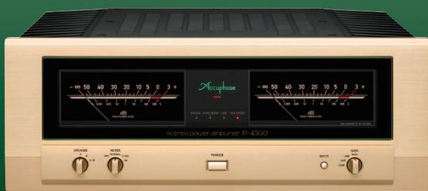
P-4500は上級機のテクノロジーを惜しみなく投入、性能や音質を大幅に向上させたAB級ステレオ・パワーアンプです。P-4500では信号入力部をディスクリート回路で構成し、信号入力部22dB、電力増幅部6dBのゲイン配分により、高いSN比121dB（ゲインMAX時）を達成しました。大型ヒートシンクには、パワー・トランジスター4パallel・プッシュプル構成の電力増幅部を搭載し、90W/8Ω、180W/4Ω、360W/2Ωのリニアなパワーと、1Ω負荷で500Wの出力（音楽信号）を達成しています。また、ダンピング・ファクターは700を誇ります。さらにブリッジ接続に切り替えれば、出力4倍の大出力モノフォニック・パワーアンプへのアップ・グレードが可能です。スピーカー端子のショート事故を防ぐ新たな保護回路を搭載し、安全性も向上しています。数々の先進技術により優れた音楽的表現力を備えたP-4500で、お好きな音楽を心ゆくまでお楽しみください。
