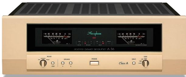
磨き上げた結晶・・・純A級ステレオ・パワーアンプの基本モデル——A-36は、A-200やA-70などの卓越した設計テクノロジーを受け継ぎ、音に対するこだわりと魅力溢れる音質を追求して、純A級ステレオ・パワーアンプとして細部に至るまで念入りに「磨き上げた」充実のベーシック・モデルです。出力素子に「パワー-MOSFET」をチャンネル当たり3パallel・プッシュプル構成、インスツルメンテーション・アンプ方式を採用して信号経路をバランス伝送化、[MCS+]回路、カレント・フィードバック増幅回路を搭載して、より一層性能・音質を向上させました。強力な電源部により、1Ωの低インピーダンス負荷で150W（音楽信号）の余裕ある出力を実現、さらにブリッジ接続にして、より大出力モノフォニック・パワーアンプにアップグレードすることができます。また、出力回路にはリレーの代わりに機械的接点がなく長期信頼性に優れた「MOSFETスイッチ」を使用するなど、最高グレードの素材や回路を巧みに駆使することにより、徹底的に低インピーダンス化し、ダンピング・ファクター：400を実現しました。
