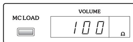
MC入力インピーダンスの切り替えは、オプション・ボードを増設したスロットを**17**INPUTセクターで選択した後にいきます。MC LOADボタンを押すと**20**VOLUMEディスプレイ部が音量レベル表示からMC入力インピーダンス表示に切り替わり、さらにMC LOADボタンを押すとMC入力インピーダンスが切り替わります。
