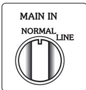
プリアンプ部とパワーアンプ部を分離し、パワーアンプ部の入力端子を選択するためのスイッチです。
