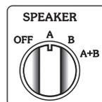
2系統のスピーカーを切り替えるためのスイッチです。
