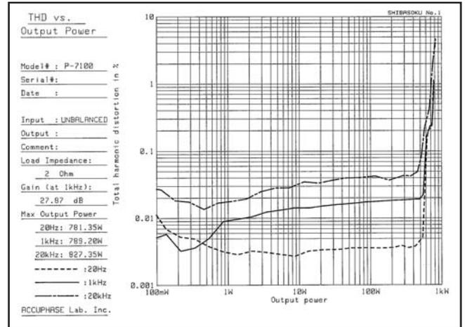
出力電力／全高調波ひずみ率特性
