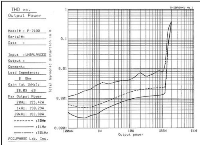
出力電力／全高調波ひずみ率特性
