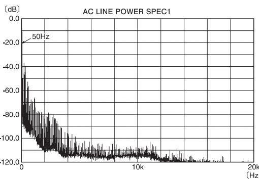
第1図 電源ライン(写真②)の周波数スペクトラム
