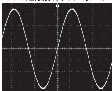
なぜこのように先端がつぶれる(ひずむ)のでしょうか。その理由は、負荷として接続される成分の中でもコンデンサーの成分が重要な意味をもちます。
