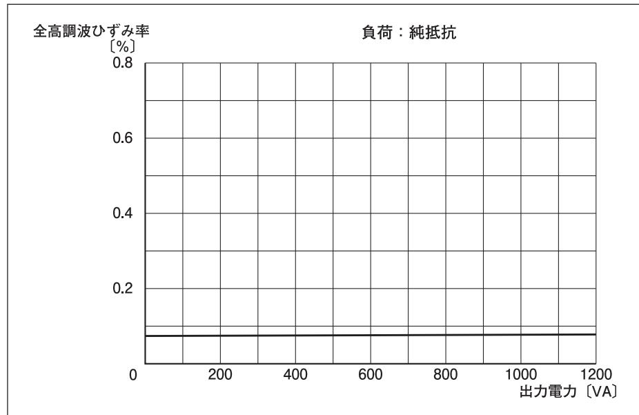
出力電力／全高調波ひずみ率特性図
