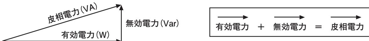
このようにオーディオ機器は電源から見た負荷として抵抗成分だけでなく、コンデンサーやコイルの成分を含むため、PS-1220等の電源は有効電力と無効電力を合わせた大きな皮相電力を担うことになります。
